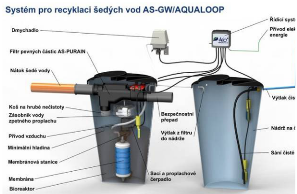
Schéma principu zařízení pro čištění a recyklaci šedé vody (zdroj: www.asio.cz )
